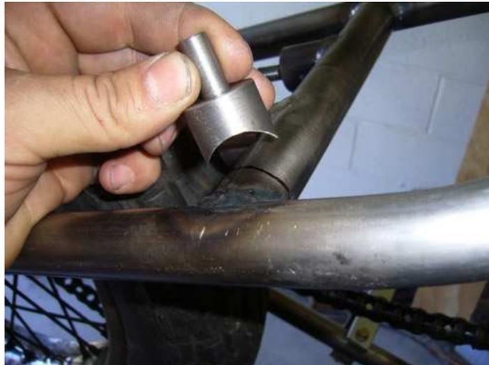
Adesso saldare il kit sul telaio ma prima assicuratevi bene che le vostre misure siano precise. Si può applicare prima una goccia di saldatura e una volta constatata la precisione passare alla fase finale di saldatura.
