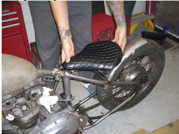
Misurare i perni sotto la vostra sella per determinare la distanza necessaria per installare il kit che conterrà le molle.
