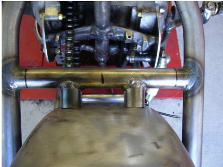
Prendere il kit di montaggio per molle e posizionarlo sulle misure segnate in precedenza, come si può vedere questo kit ha la parte inferiore arrotondata per rendere il montaggio più semplice possibile.
