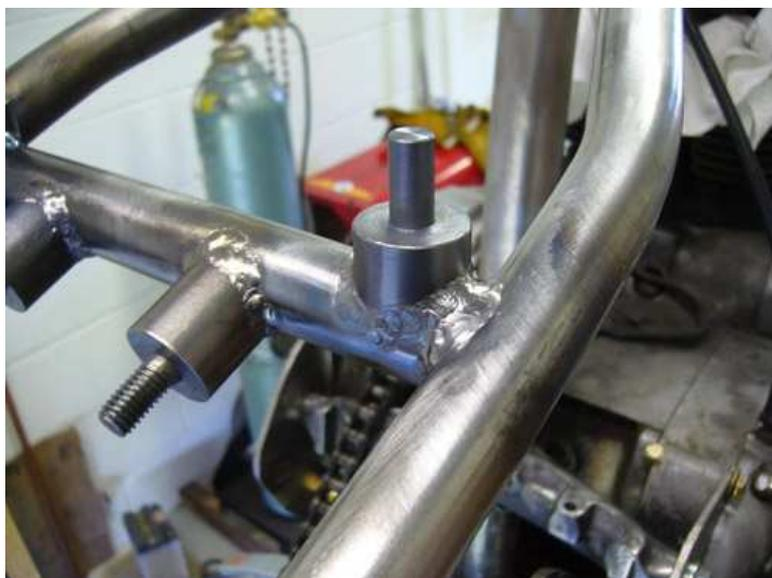
Adesso stringere i perni della staffa alla sella e ancora una volta segnare la posizione dove verrà saldata la staffa alla parte anteriore del telaio.
