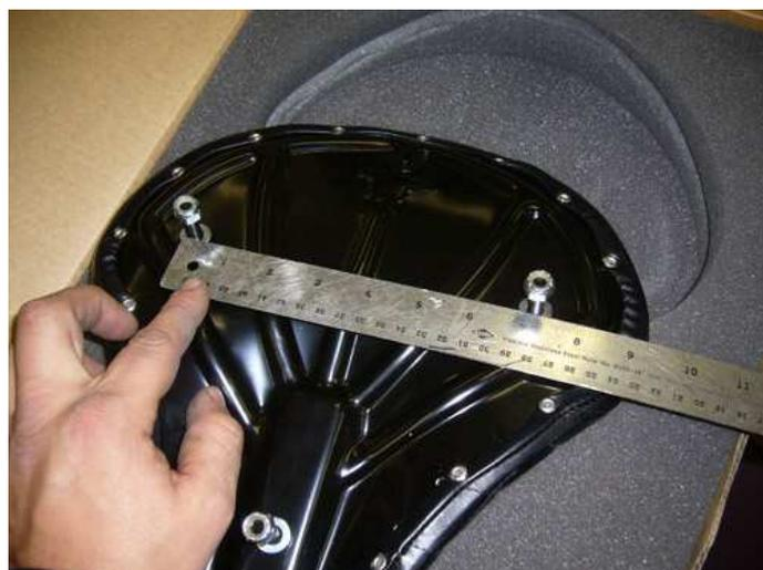
Una volta prese le misure dei perni della sella segnare sul vostro telaio la stessa distanza.
