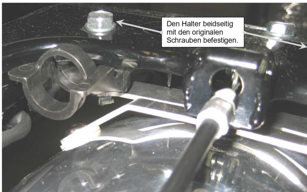
Zum Schluss den Kotflügel mittig ausrichten und alle Schrauben festziehen.
