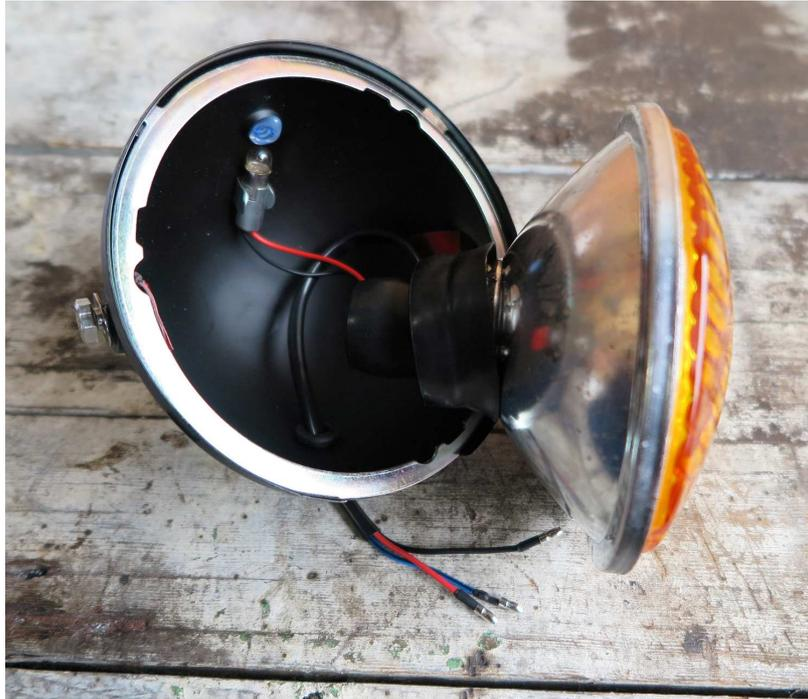
Fissare la lampadina che indicherà che il faro è nella posizione abbagliante nell'apposito alloggiamento.
