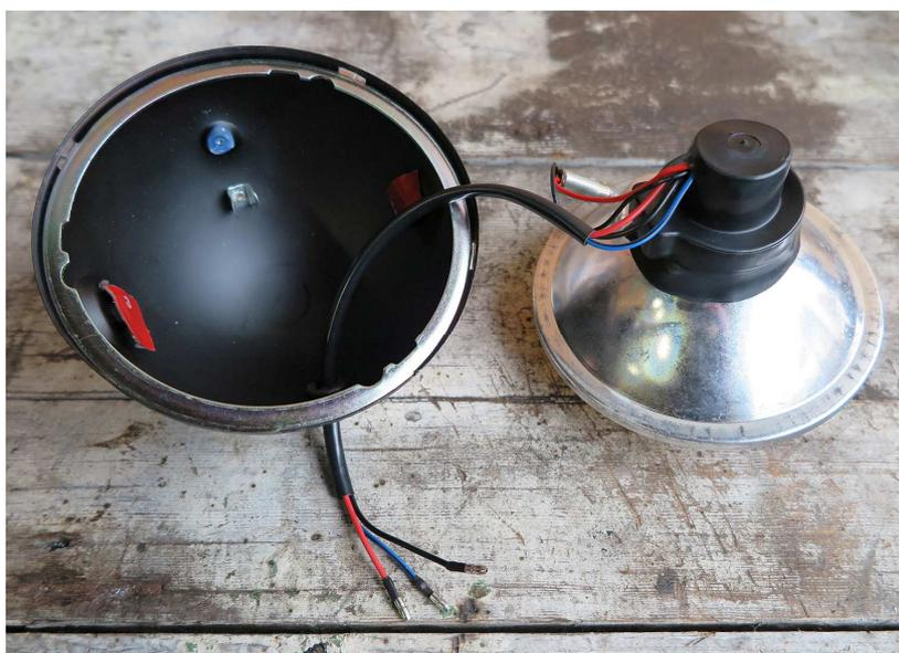
Far passare il cavo di collegamento nel foro situato nella parte inferiore dell'alloggiamento.
