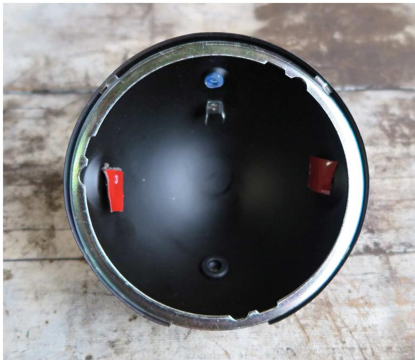
Inserire l'anello di fissaggio della parabola bloccando le 2 linguette nelle apposite scanalature poste nella parte superiore dell'alloggiamento.
