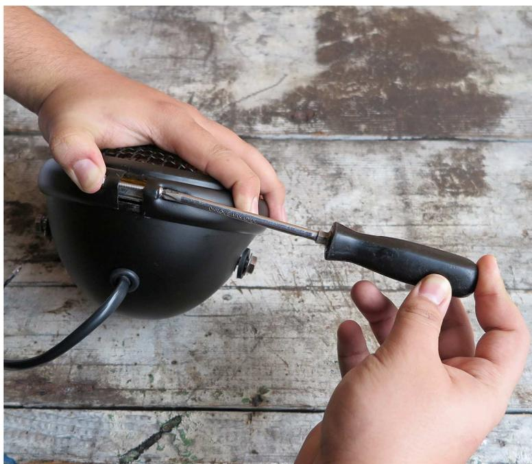
Chiudere l'anello mediante vite e dado in dotazione.
